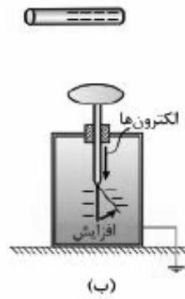
(ب) با نزدیک کردن میله با بار منفی، الکترون‌ها از کلاهک به تیغه‌ها مهاجرت می‌کنند.
