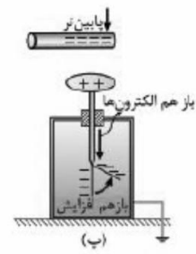
(پ) بار هم الکترون‌ها با کلاهک نزدیک کنیم، بار هم الکترون بیشتری از کلاهک به تیغه‌ها منتقل می‌شود (یعنی کلاهک مثبت می‌شود).
