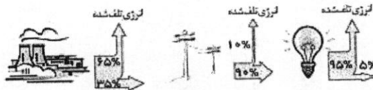
انرژی مفید لامپ رشته ای انرژی مفید خطوط انتقال توان الکتریکی انرژی مفید نیروگاه سوخت فسیلی یا هسته ای
